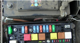
Блок предохранителей
