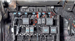
Блок предохранителей
